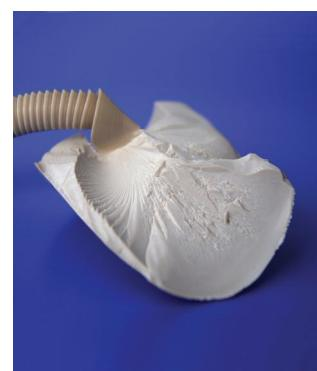
Заготовка, треснувшая из-за большого размера срезаемой стружки состояния. Соответствующие указания Вы найдёте в таблице 3 на следующей странице.
