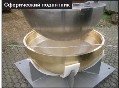
Сферический подпятник из ZX-324 для опоры главной ходовой части в самых больших экскаваторах. Диаметр шара 1000 мм.
