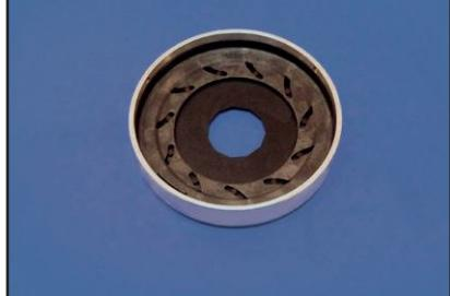
ZX-410V7T применяют как направляющую диска из-за высокой износостойчивости и стабильности размеров в высокотехнологичных линзах камер. Пластинчатое кольцо закрывает объектив/линзу. Требуются очень жесткие допуски в литье под давлением, высокая износостойкость, очень низкий коэффициент теплового расширения (рабочая температура от -40 до +60 градусов С). Заменен алюминий из-за высокого износа
