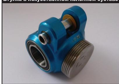
Подшипники скольжения из ZX-750V5T выполняют предельные требования искусственного коленного сустава. Необходимы высокое давление на поверхность и высокая износостойкость, чтобы не превышать максимальный зазор в 0,05 мм.
