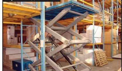
Подъёмный механизм для подъёмного стола. Заменяется бронза на ZX-100K. После чего не требуется технического обслуживания.
