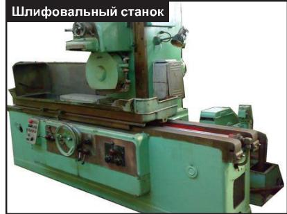
Направляющая скольжения из ZX-100K для шлифовального станка. Заменен материал бронза. Простота обслуживания, благодаря работе всухую.
