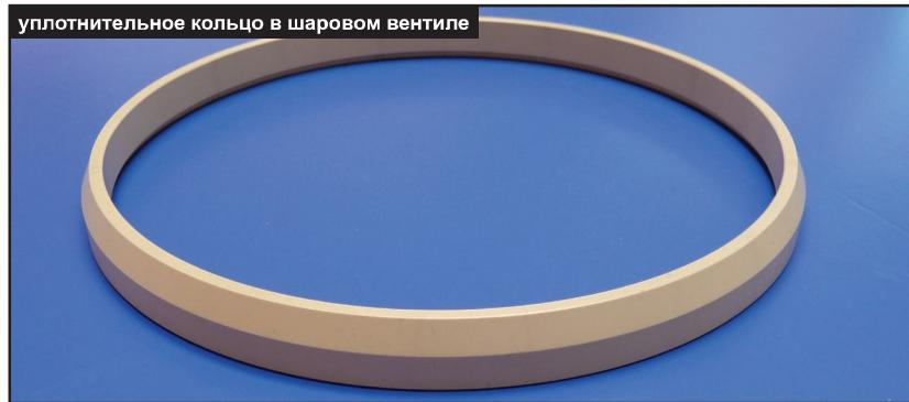
Уплотнительное кольцо из ZX-530 в шаровых вентилях. ZX-530 применяется в качестве уплотнительного кольца в шаровых вентилях (до 180°C) из-за своей более высокой, по сравнению с фторопластом, длительной прочности и хороших антифрикционных свойств.
