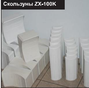
Скользуны из ZX-100K применяются для направления и выдвижения секций телескопических стрел автомобильных кранов грузоподъемностью свыше 40 тонн. Стрема состоит из 4 секций, которые выдвигаются на длину от 11 до 34 метров. Температура применения от -40 °C до +40 °C.
