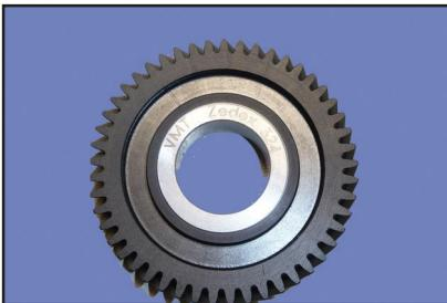
Шестерня из ZX-324VMT устанавливается на стальную втулку способом формования питьём под давлением и переносит высокие нагрузки при температуре до 150°C.
