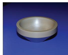
Деталь из ZX-324 диаметром 60 мм, выдерживает нагрузку в 30 тонн, удары и загрязнение.
