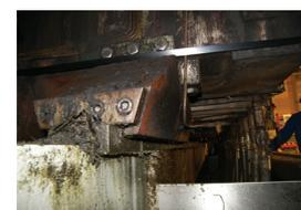
Направляющие скольжения в прессе были заменены на направляющие из ZX-750V5T. Благодаря высоким рv-значениям и износоустойчивости ZX-750V5T, стала возможной работа без смазочных материалов.
