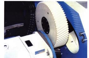
Шестерня из ZX-100K. Модуль 5 мм. Передаваемая мощность 38 kW. Работа без смазывающих материалов.
