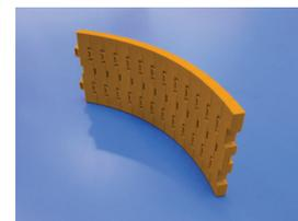
Сегмент втулки из ZX-750V5T -диаметр 700мм-для направления противовеса в 28-тонном подводном молоте. Ударная частота 50Hz.
